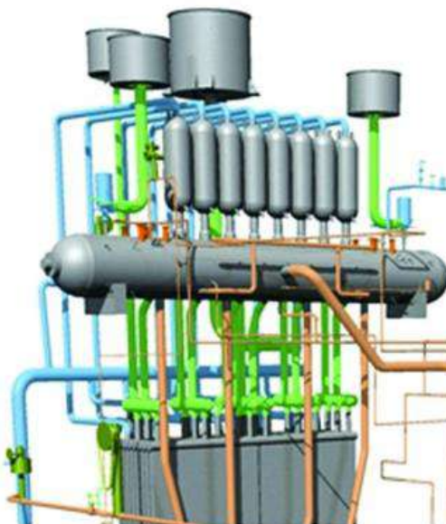
Рисунок 4. 3D-изображение барабана DrumPlus с группой вторичных вынесенных сепараторов [3]
